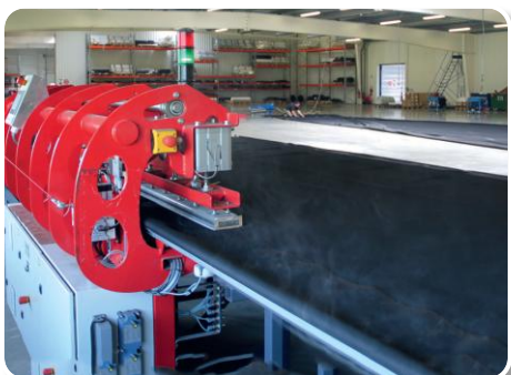
Assemblage des lés en 2D
