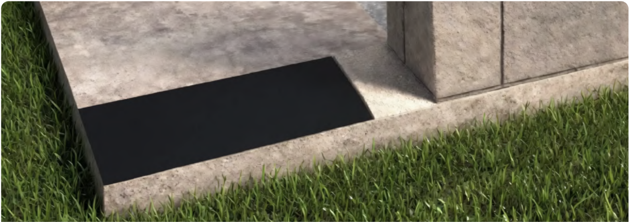
Application d'une bande d'arase pour assurer l'étanchéité contre les remontées d'humidité
