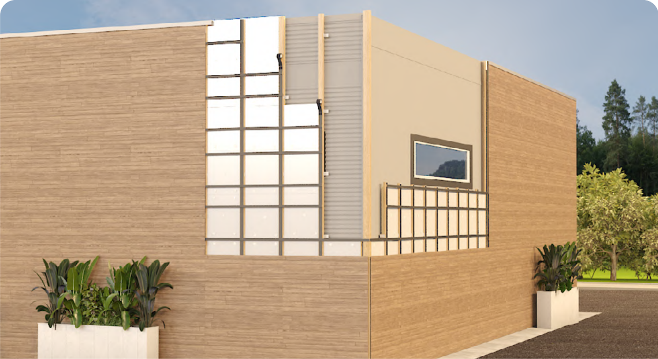
Application ddes bandes d'étanchéité afin de sécuriser l'étanchéité en sous bardage rapporté
