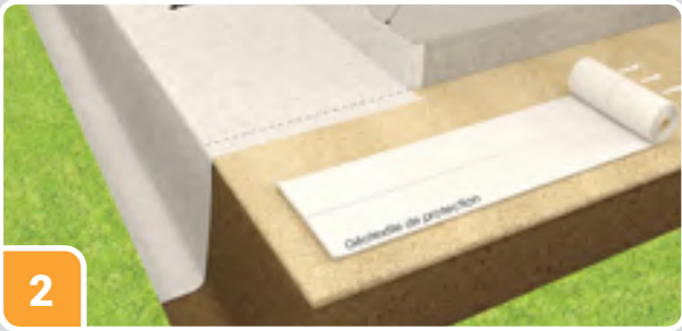
1 Poser le géotextile de protection et le découper au niveau de l'angle
