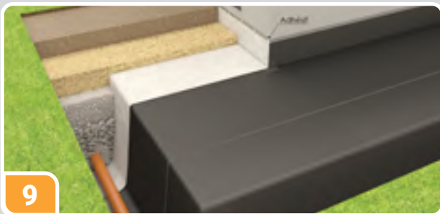
7 Poser la 2 ème membrane en la raccordant avec la 1 ère déjà posé en la fixant avec des profilés de fixation
