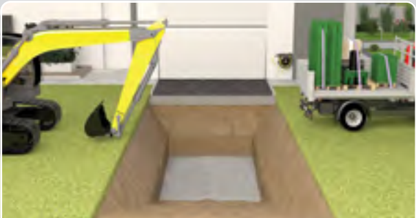
Réaliser le terrassement et le lit de pose en graviers
